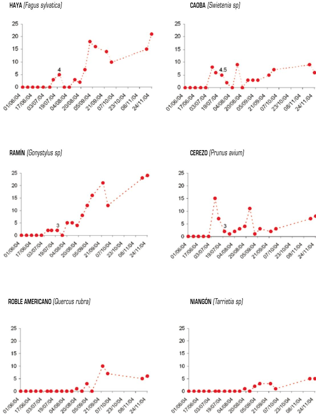
Figura 1. Resultados del seguimiento de la resistencia de distintos tipos de maderas, frente a la colonización por parte del mejillón cebra. En ordenadas se recoje el número de individuos encontrados y en abscisas las fechas de seguimiento. Sobre las mismas figuras, se indica la longitud en mm del ejemplar de mayor tamaño encontrado para medidas superiores a 1,5 mm.
