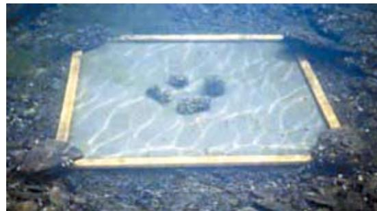
Foto 2. Manta bentónica colocada en el lugar en que se pretende la eliminación de una colonia de mejillón cebra.
