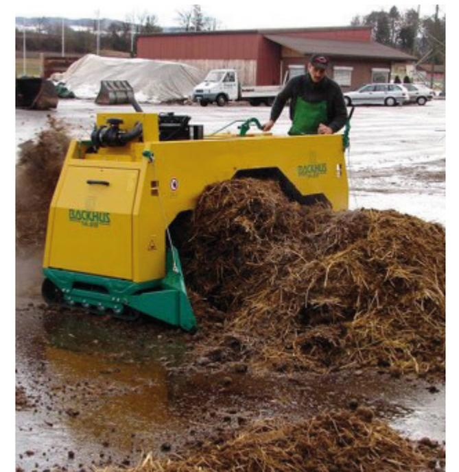
Sistema de volteo en pequeñas instalaciones con volteadoras autopropulsadas
