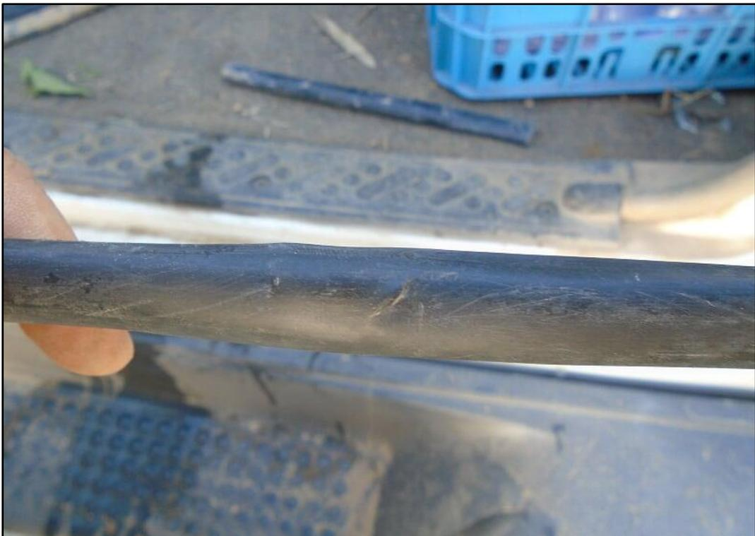
*Figura 37. Rotura detectada en una manguera a fecha 21/09/2018.*
